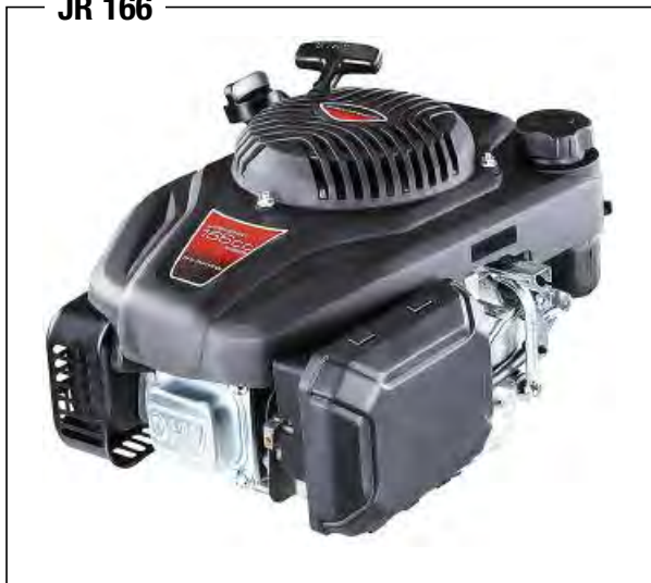
JR 166 Motore benzina Loncin per rasaerba - Albero cilindrico verticale 22,2 x 60 mm Cilindrata 166 cc - 6 HP - Avviamento a strappo - Volano standard - Euro 5
